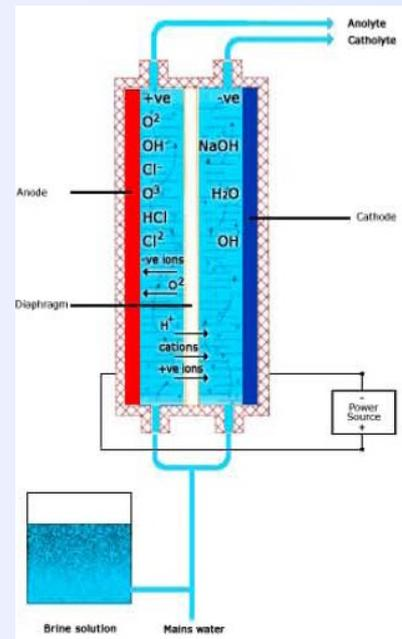
Oltre a disinfettare l'acqua, l'Anolyte distrugge il biofilm nelle condotte di distribuzione e elimina i focolai di contaminazione microbiologica.
